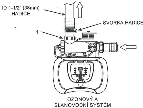
1. Připojte adaptér A (1) na výstup Ozonového a slanovodního systému. Pevně utáhněte.
