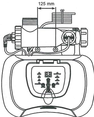
1. Montážní otvory mají průměr 6,4 mm a jsou v odstupu 125 mm od sebe.
