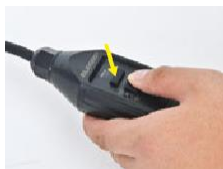
3. Stiskněte tlačítko «TEST» a ukazatel zhasne.
